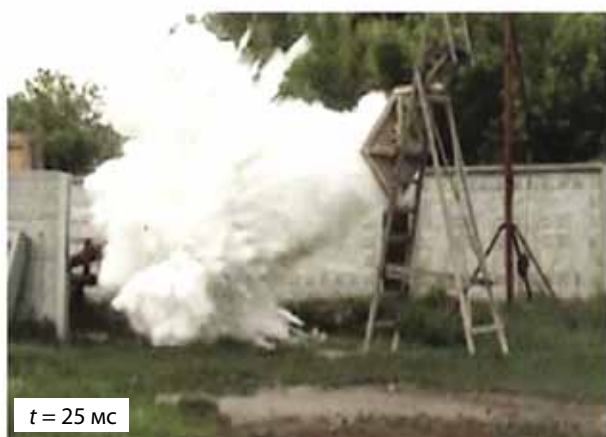
Рис. 1. Формирование факела распыления заряда порошка во времени
