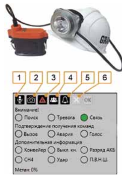
Рис. 3. Система «SBGPS» – дополнительная панель на АРМ горного диспетчера при работе с УО для отправки вызовов и аварийных оповещений:
