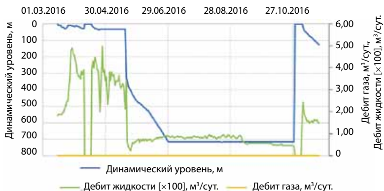
Рис. 8. Диаграмма эксплуатационных показателей скважины Ш-3 Fig. 8. Diagram of operational indicators of the Ш-3 well
