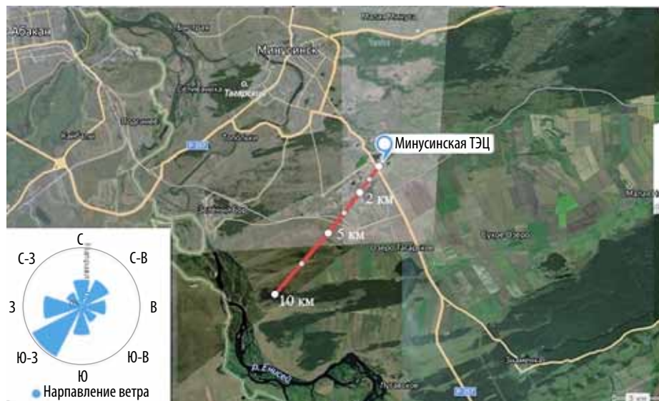
Карта-схема отбора почвенных проб вблизи территории Минусинской ТЭЦ Красноярского края (удаление от ТЭЦ – 2 км, 5 км и 10 км в юго-западном направлении)
