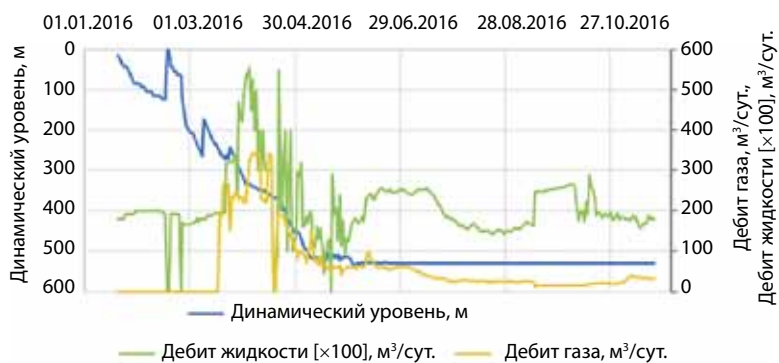
Рис. 6. Диаграмма эксплуатационных показателей скважины Ш-4 Fig. 6. Diagram of operational indicators of the Ш-4 well
