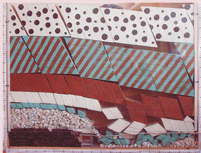
Рис. 2. Стенд для испытания предложенной крепи
