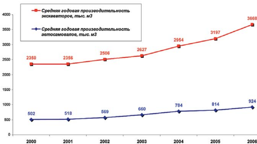
Рис.3. Средняя годовая производительность экскаваторов и автосамосвалов на разрезе «Нерюнгринский» за 2000-2006 гг.
