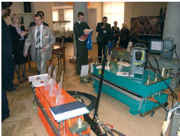
ОАО «Боровичский завод «Полимермаш» — основной производитель и поставщик переносных вулканизационных прессов и кабельных вулканизаторов для различных отраслей промышленности. В настоящий момент на предприятии выпускаются 8 типов прессов в более чем 150 модификациях, позволяющих производить ремонт и стыковку конвейерных лент шириной до 2500 мм как на поверхности, так и в условиях угольных шахт. Оборудование ОАО «Боровичский завод «Полимермаш» работает не только на горно-металлургических и угольных предприятиях России и других стран СНГ, но и на конвейерах в Африке, Монголии, Вьетнаме и еще многих стран мира.
