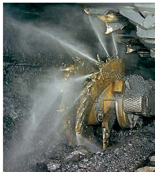
Рис. 4. Сравнение эжекторного орошения линии резания с традиционным орошением (РАГ)
