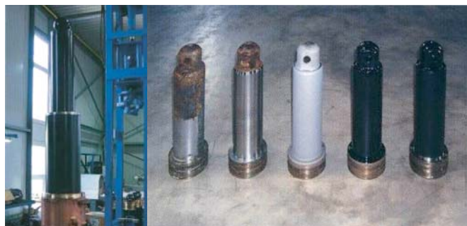
Пример применения технологии нанесения полимерных покрытий при ремонте штока гидростойки
