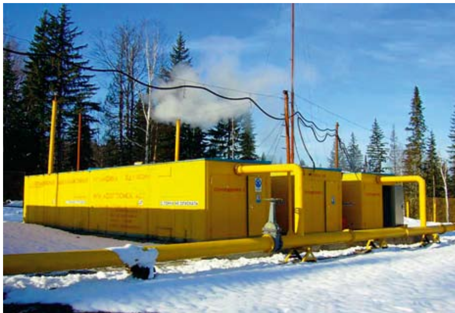
Рис. 2. Мобильные дегазационные комплексы из двух (100 м 3 /мин) и трех (150 м 3 /мин) установок ПДУ-50-1 в помещениях для дегазационных работ с поверхности в полевых условиях
