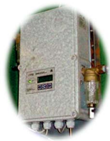
Рис. 2. Станция контроля параметров метановоздушной смеси в дегазационном трубопроводе
