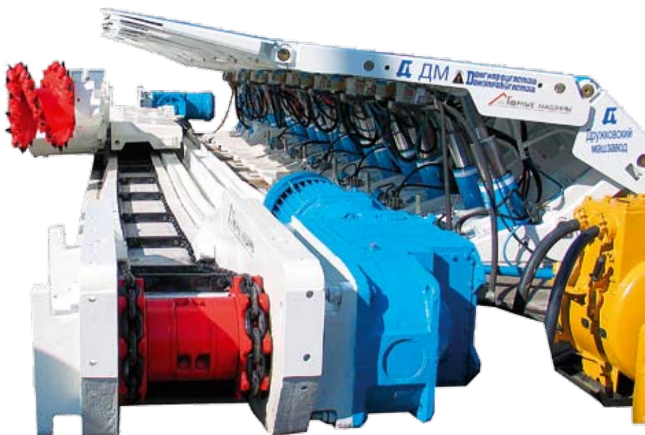
Очистной комплекс МДМ
