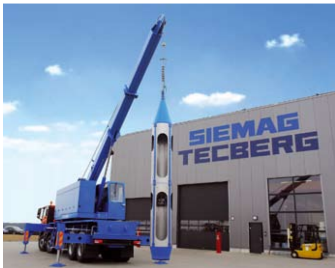
Мобильная шахтная лебедка в рабочем положении
