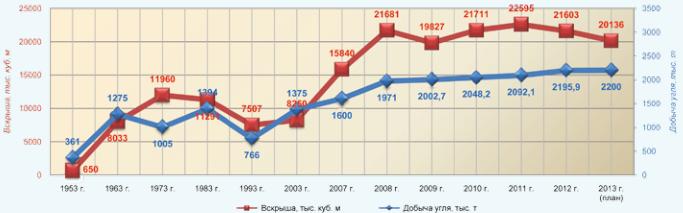
Рис. 1. Динамика объемов добычных и вскрышных работ на разрезе «Киселёвский»
