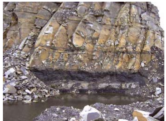
Рис. 4. Клинообразная трещиноватость пород кровли угольного пласта D_7^B Чульмаканского каменноугольного месторождения
