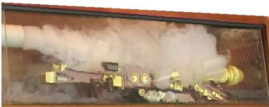
Рис. 2. Схема распространения визуализированного потока свежего воздуха из вентиляционной трубы в сторону забоя выработки
