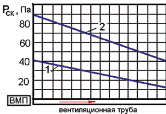
Рис. 1. Схема изменения динамического давления в воздуховоде при замерах вне горной выработки
