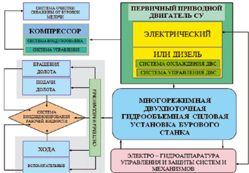
Рис. 1. Структура взаимодействия приводов механизмов карьерного бурового станка и их активация в течение его рабочего цикла при однозаходном и многозаходном способах проходки скважины
