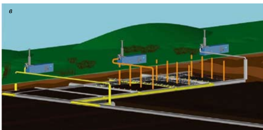
Схемы дегазации на различных этапах отработки блока: а — 1-й лавы; б — 2-й лавы; в — 3-й лавы
