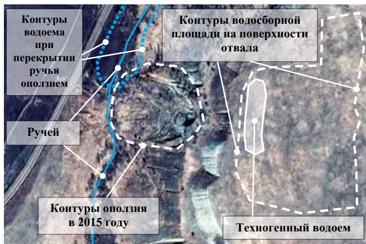
Рис. 1. Фрагмент космоснимка внешнего породного отвала в районе оползня
