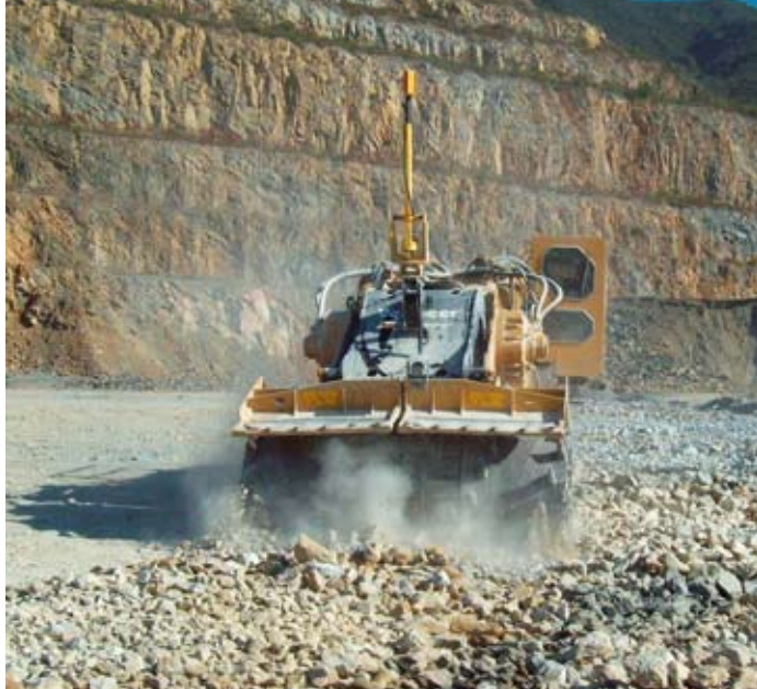
T1255 Terrain Leveler с приводной цепью, например, работает в Китае на известняках с коэффициентом крепости 130 МПа, добывает до 1000 т в час. Машина T1655 Terrain Leveler дает увеличение производительности в 2,5 раза больше
