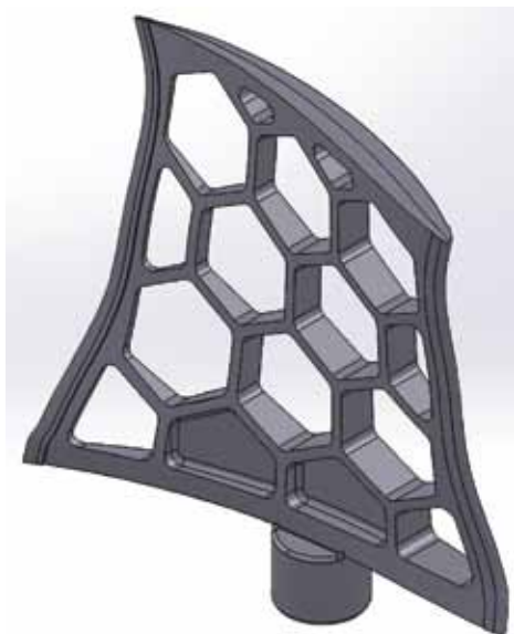
Рис. 1. Рабочая лопатка вентилятора с сотовой структурой
