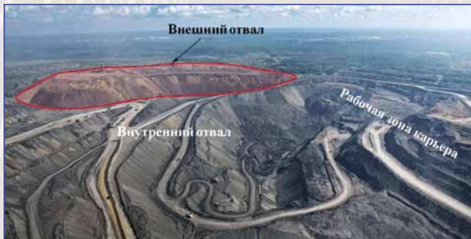
Рис. 2. Комбинированный (компенсационный) отвалный массив на разрезе «Черниговец» (АО ХК «СДС-Уголь»)
