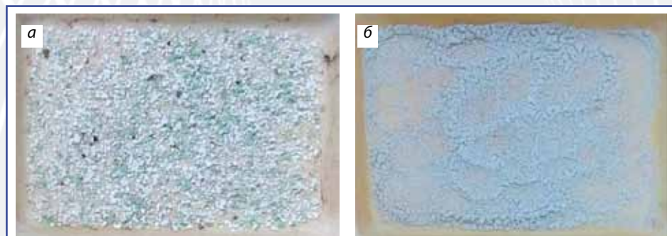
Рис. 2. Зольные остатки образцов: а – УТО-1 фракции 0,5-1 мм, б – УТО-2 фракции 0,05-0,1 мм Fig. 2. Ash residues of samples: a – UTO-1 fractions of 0.5 to 1 mm, b – UTO-2 fractions of 0.05 to 0.1 mm
