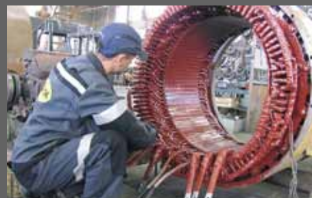
Ремонт электрооборудования до 2500 кВт
