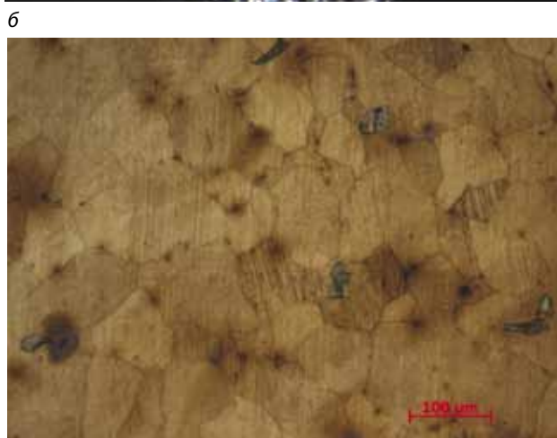
Рис. 2. Фрактограмма (а) и микроструктура (б) стали 110Г13Л×100
