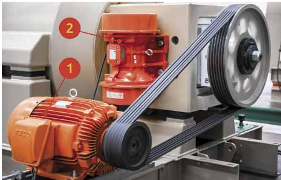
Рис. 4. Приводной электродвигатель (1) и один из вибромоторов (2)
