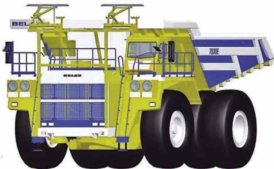
Рис. 1. 3-D модель дизель-троллейвоза грузоподъемностью 240 т
