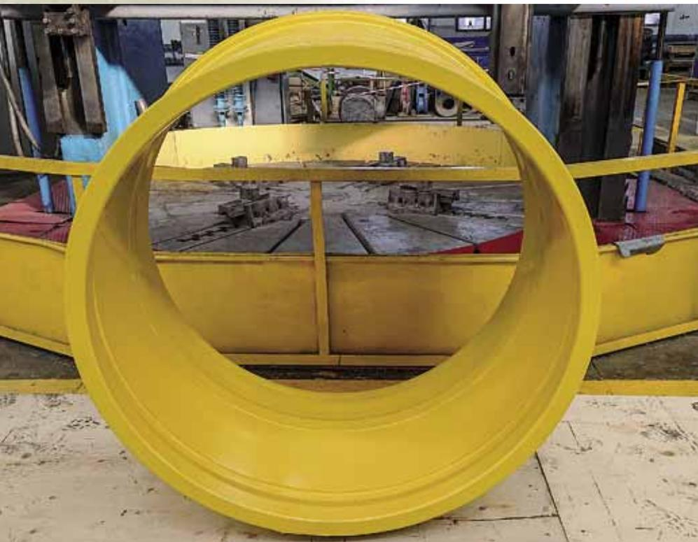
Колесные диски для большегрузного транспорта изготовлены из поковок высокопрочной низколегированной конструкционной стали (Q345B, стандарт GB/T 1591-2008) методом аргонно-дуговой сварки на частотно-регулируемом поворотном устройстве.
