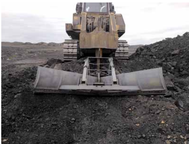
Рис. 1. Навесной агрегат для рекультивации переуплотненных автомобильных отвалов угледобывающих предприятий
