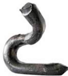
Рис. 3. Звено цепи, разрушенное при «жесткой блокировке»
