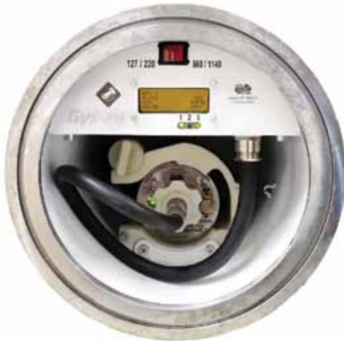
Рис. 4. Зафиксированная батарея внутри корпуса взрывозащищенного зарядного устройства «БУРАН»
