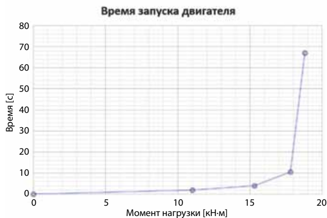
Рис. 1. Время запуска двигателя / двигателей в зависимости от момента нагрузки для виртуального забоя (см. таблицу), кН·м
