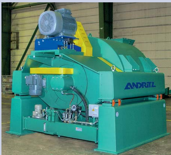
Вибрационная центрифуга АНДРИТЦ непрерывного действия для обезвоживания мелкого угля класса 0,5 – 13 (25) мм Типоряд HES
