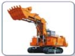
Два 29-кубовых карьерных экскаватора Hitachi EX-5500
