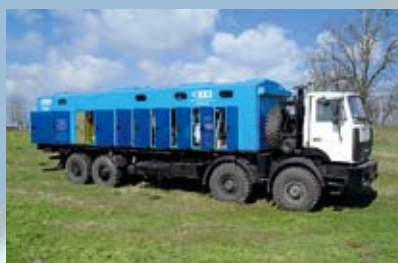
ТГА-20/251 — компрессорная станция на шасси МЗКТ Производительность — 20 м 3 /мин; Давление — 251 атм; Чистота азота — 95-97 %.
