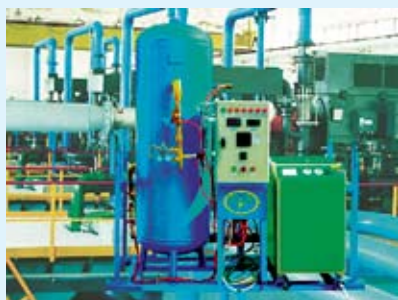
АМУ-2/12-99 Производительность — 2 м 3 /мин; Давление — 12 атм; Чистота азота — 99 %.
