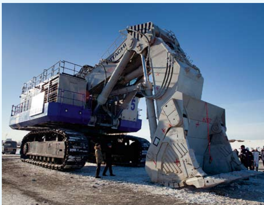
Экскаватор Hitachi с ковшом вместимостью 27 куб. м
