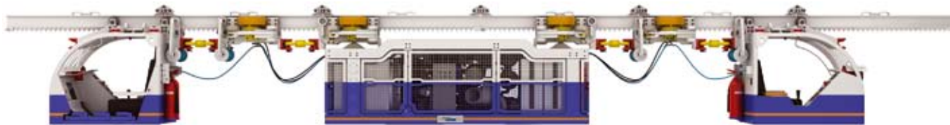
Рис. 1. KPCS-96 — подвесной дизель-гидравлический локомотив с фрикционным приводом
