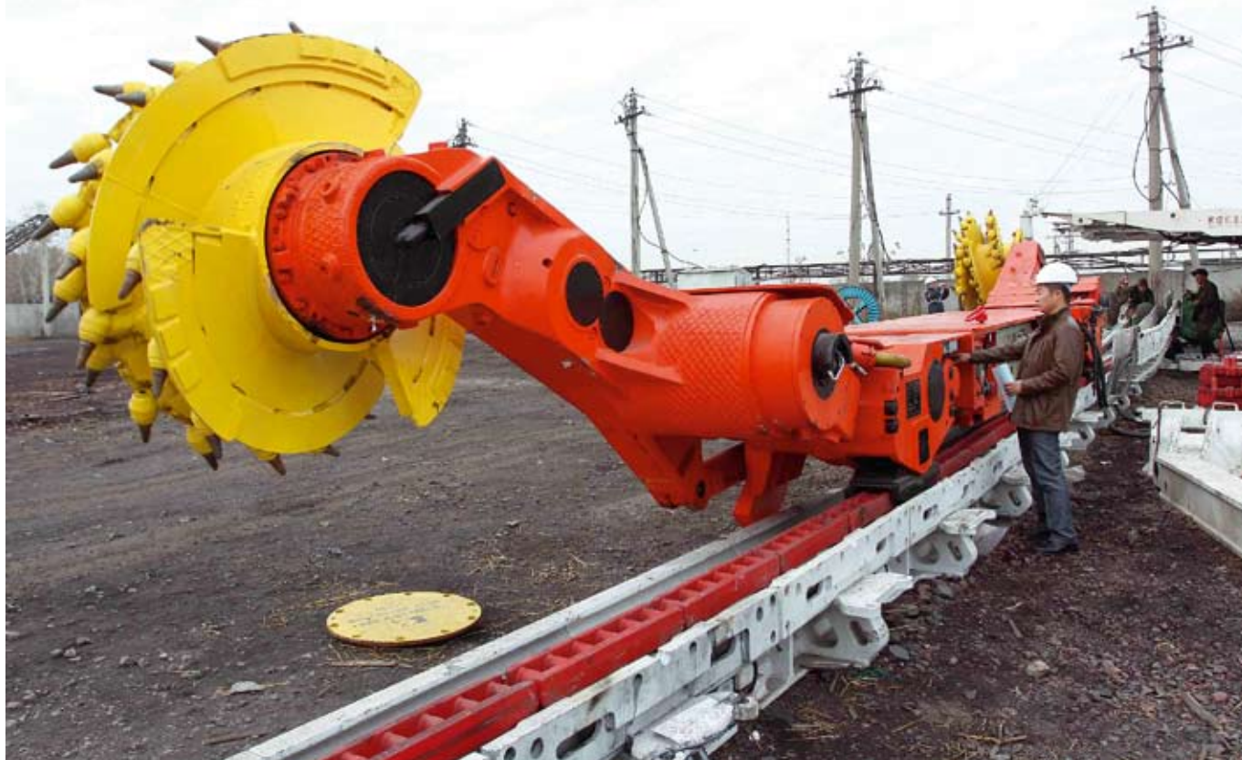
Сборка очистного механизированного комплекса ZY 6400/15/34D на промплощадке шахты «Чертинская-Коксовая»
