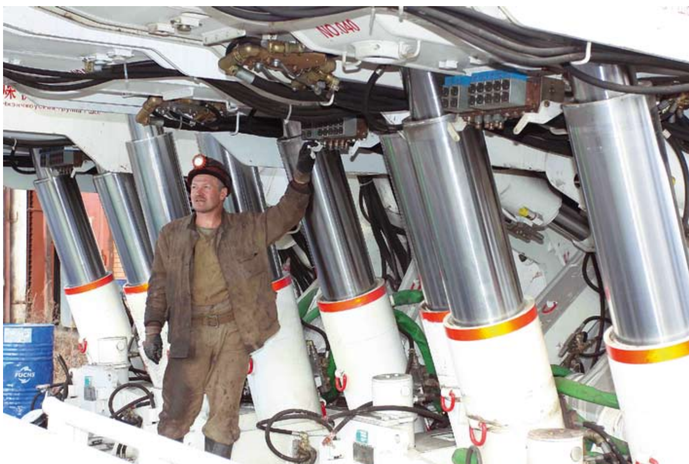
Сборка очистного механизированного комплекса ZY 6400/15/34D на промплощадке шахты «Чертинская-Коксовая»
