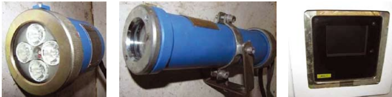
Рис. 2. Система видеоконтроля (пржектор, камера, монитор)
