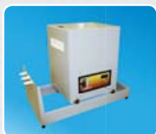
Печи GK для определения спексаемости по Грей-Кингу
