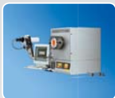
Печь для определения плавкости золы угля CAF
