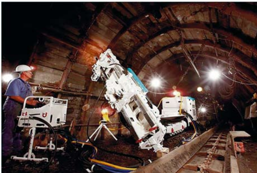
Рис. 12. Применение буровой установки EN 220-65 на гусеничном ходу
