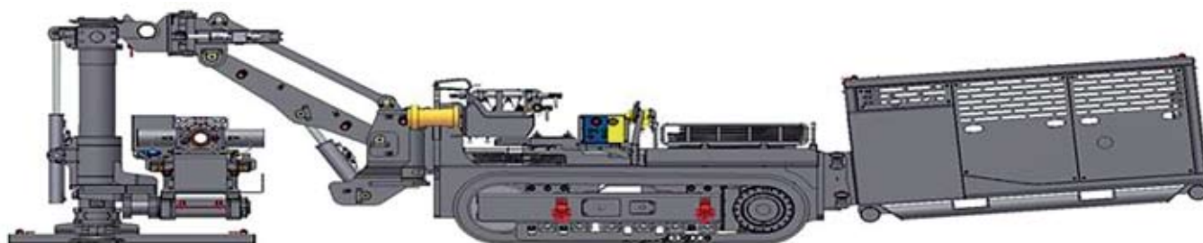
Рис. 11. Электрогидравлическая буровая установка EH 260 с гусеничным самоходным шасси и блоком питания
