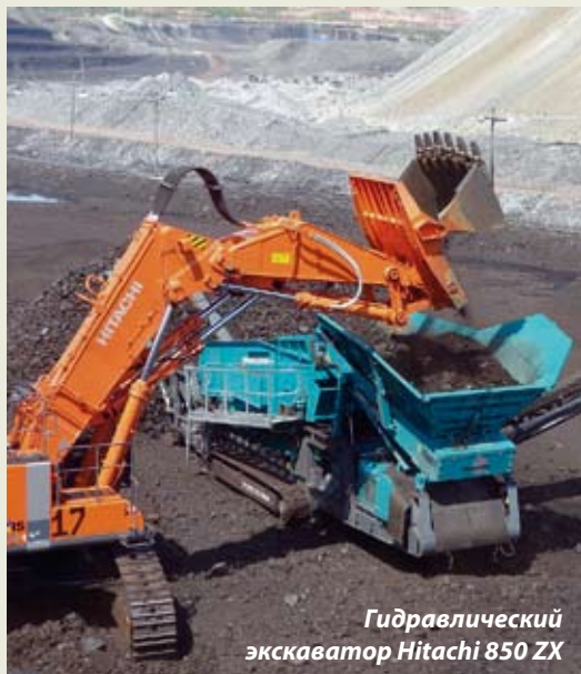
Мобильная сортировочная установка Warrior 2400
