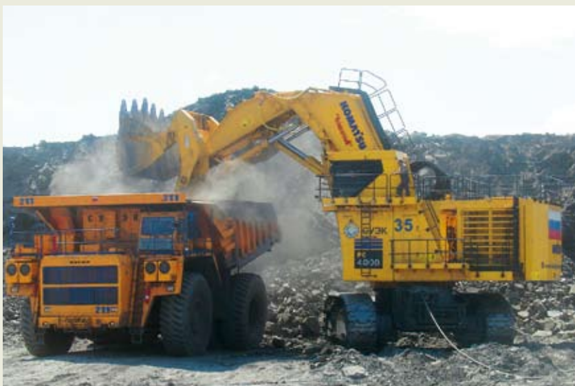
Рис. 4. Погрузка вскрышных пород в автосамосвал БелАЗ-75306
