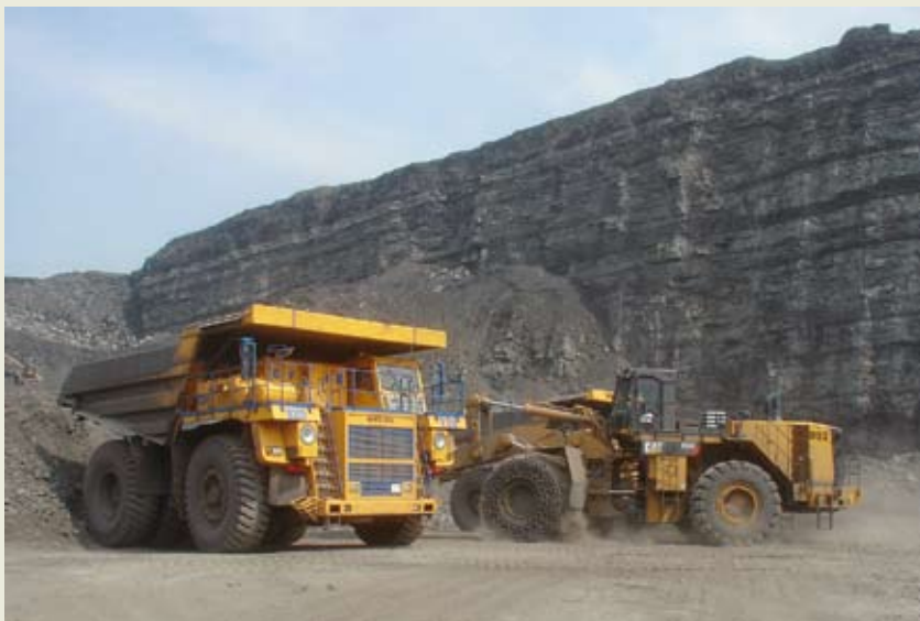
Рис. 2. Фронтальный погрузчик CATERPILLAR-992C с вместимостью ковша 13 куб. м
