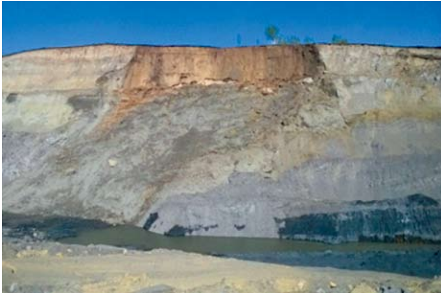
Рис. 2. Неустойчивые породы рабочего борта и обводненность почвы угольного пласта «Кыргайский 63»
