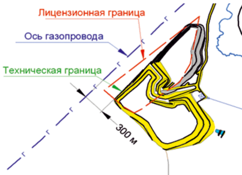
Рис. 1. Техническая граница участка с учетом охранного целика под коммуникационный коридор газопровода «Парабель — Кузбасс»
