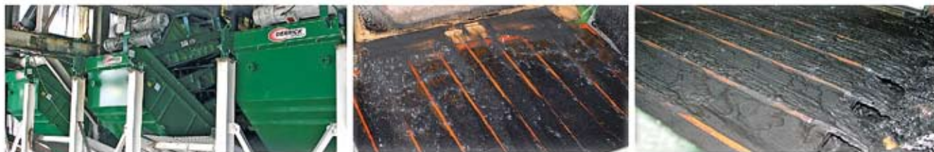
Рис. 2. Три грохота Stack Sizer™ на фабрике White County Preparation Alliance Coal Company и полиуретановые панели в работе
