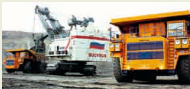
Работа экскаватора с погрузкой вскрышных пород в автосамосвалы на два подъезда
