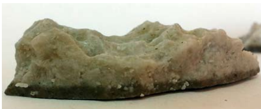
Рис. 5: а — EDS-спектры Li-Na-K карбонатной эвтектики до и после взаимодействия с золой; б — разделение летучей золы в охлажденной Li-Na-K карбонатной эвтектике. Нижний темный слой соответствует золе Fig. 5: (a) – EDS-spectra of the Li—Na—K carbonate eutectic before and after exposure to fly ash; (b) – Segregation of the fly ash in the cooled Li—Na—K carbonate eutectic. The bottom dark layer is the fly ash
