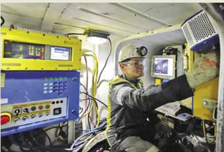
Пульт дистанционного управления комплексом FRS Glinik 12/25 на конвейерном штреке
