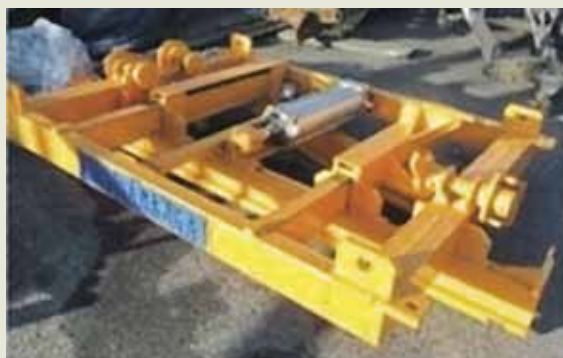
Автоматический пневматический стрелочный перевод
