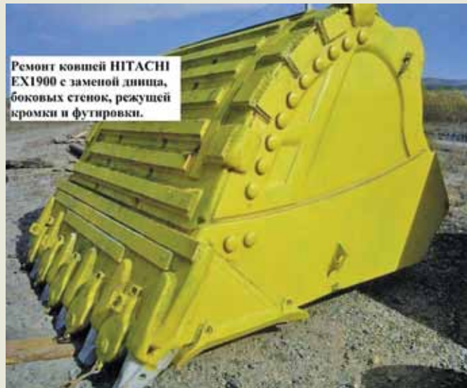
Отремонтированный на Черновских ЦЭММ ковш Hitachi EX1900
