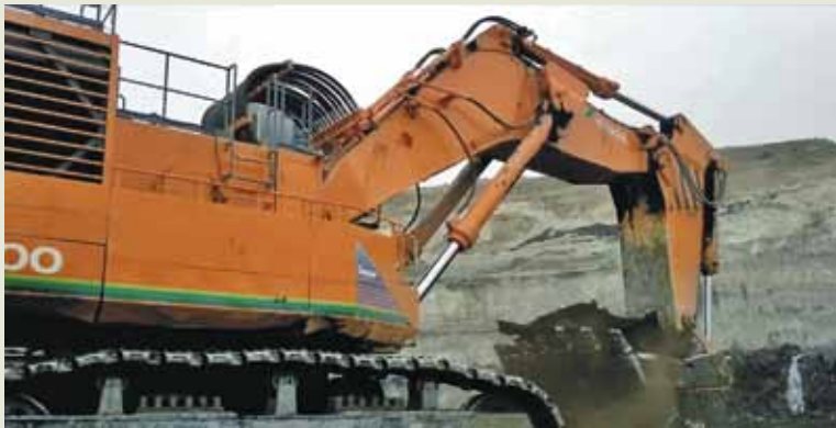
Экскаватор Hitachi EX2600 (вместимость ковша 15 куб. м)
