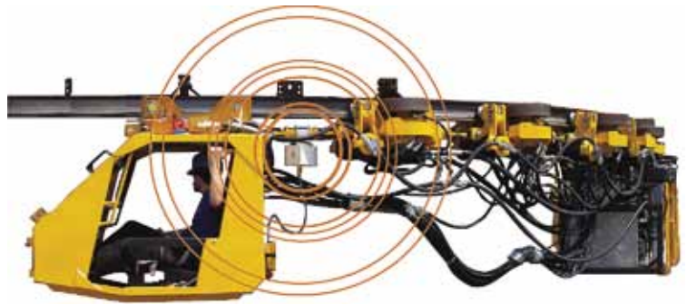
Рис. 2. Контроллер GAL, установленный на ДГЛ DLZ110F производства ООО «Феррит», Чехия
