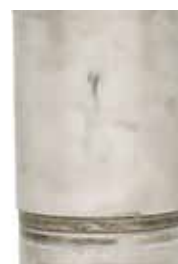
Гильза двигателя, который работал с оригинальной охлаждающей жидкостью, имеющей антикавитационные присадки
