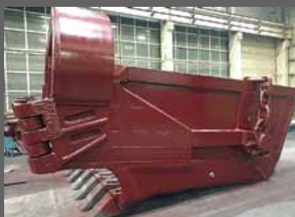
Изготовление ковшей ЭШ-20/90
