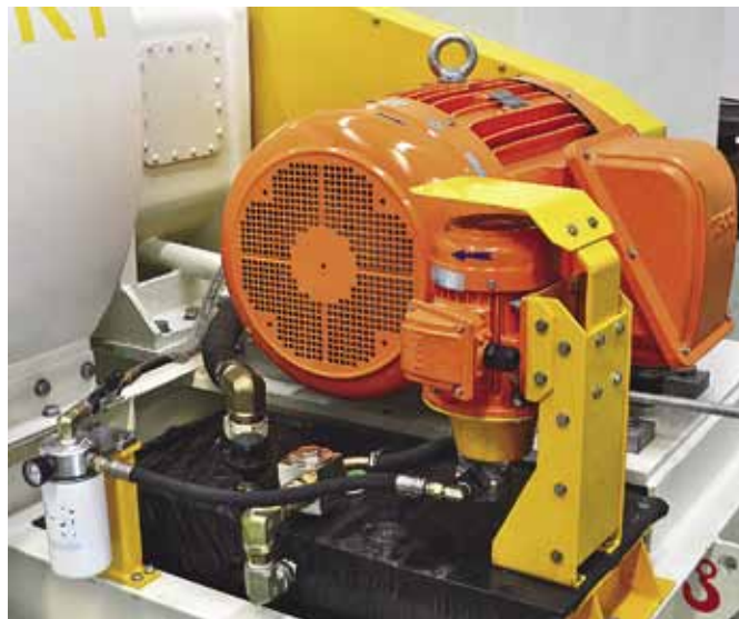
Рис. 5. Приводной электродвигатель и система смазки
