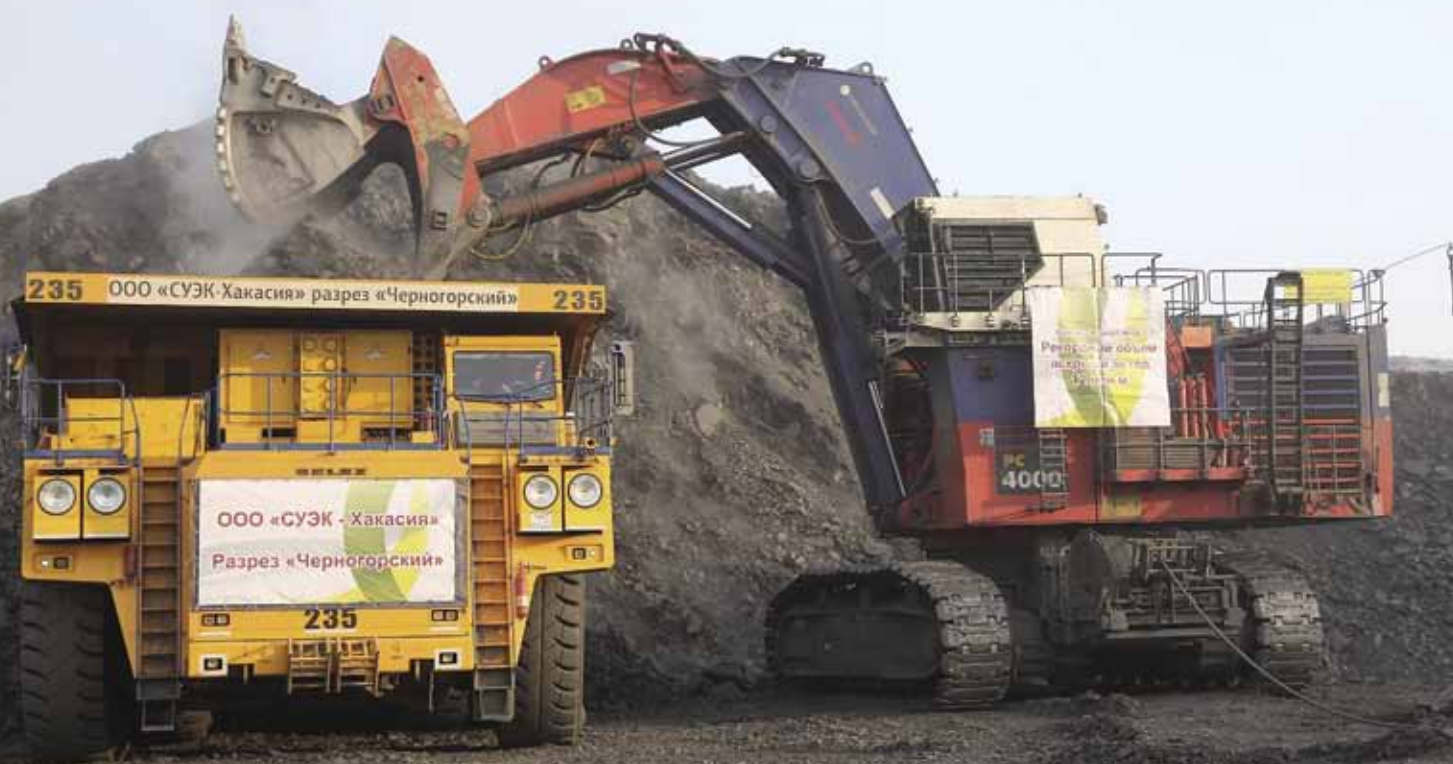
Рис. 4. Экскаватор KOMATSU PC-4000 (емкость ковша 22 м 3 ) с погрузкой в автосамосвал БелАЗ-75306 (грузоподъемность – 220 т)
