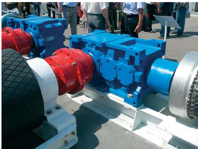
Рис. 2. Редуктор RXO 2/818 в составе приводного блока конвейера КЛКТ-1200
