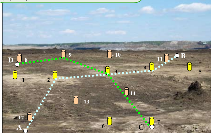
Рис. 2. Схема взятия проб почв на полигоне после снятия ПСП (разрез «Бородинский», 2007 г.)
