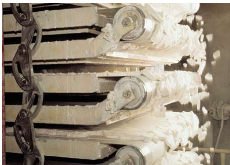
Движущаяся фильтроткань в автоматических пресс-фильтрах Larox транспортирует на себе кек наружу из каждой камеры, весь без остатка, в каждом цикле. Не требуется никакого вмешательства оператора
