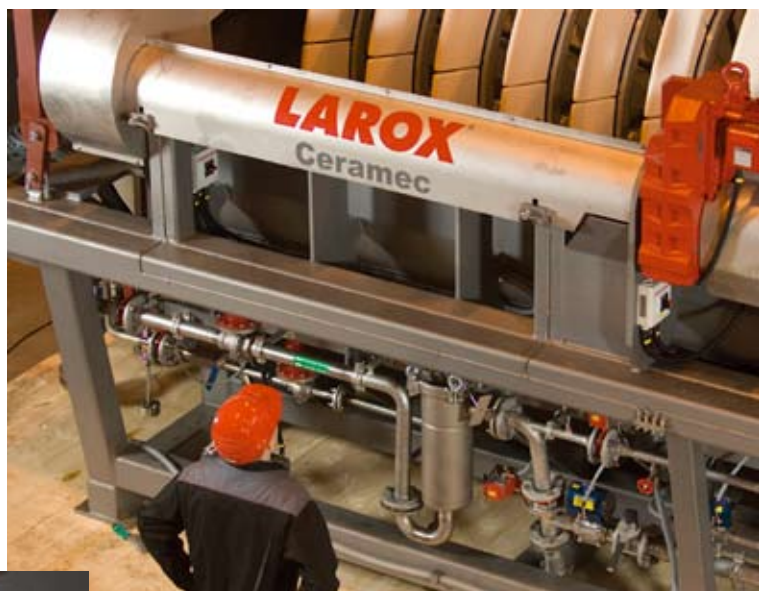
Керамические фильтры Ceramec особенно пригодны для фильтрации суспензий в горной и металлургической отраслях промышленности. Материал дисков инертен к большинству составов пульп в широком температурном диапазоне и имеет длительный срок службы.
