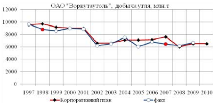
Рис. 2. Позиционирование взрывов метана (1998 г., 2007 г.) на графике динамики добычи угля на шахтах ОАО «Воркутауголь»
