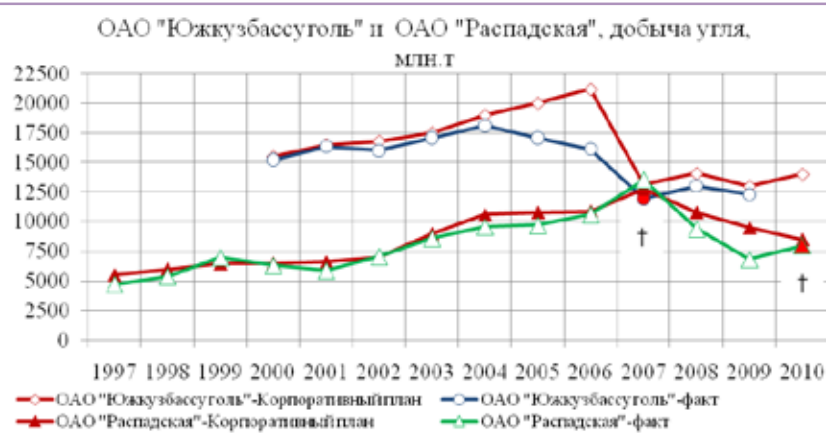
Рис. 3. Позиционирование взрывов метана (2007 г. и 2010 г.) на графиках динамики добычи угля на шахтах ОАО «Южубассуголь» и ОАО «Распадская»
