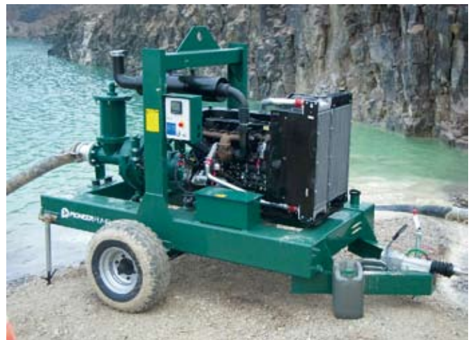
Рис. 2. Мобильная (на двухколёсном шасси) насосная установка Pioneer 100SH с двигателем Perkins 1106 (производительность 250 м 3 /ч, напор 60 м)
