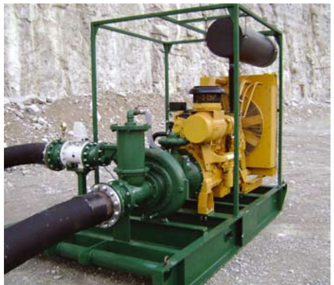
Рис. 3. Передвижная (на салазках) насосная установка Pioneer 100SH с двигателем Caterpillar C9 (производительность 400 м 3 /ч, напор 115 м)
