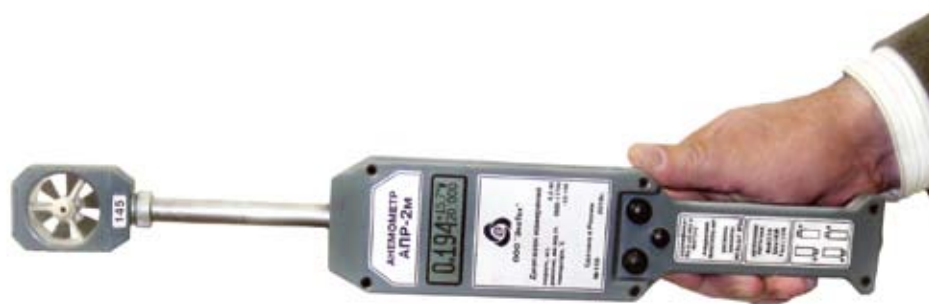
Анемометр рудничный АПР-2м
