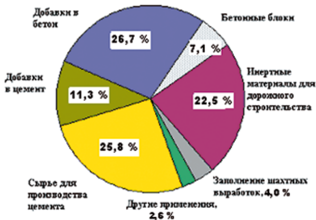
Рис. 1. Утилизация золы от сжигания углей в строительной промышленности и для заполнения горных выработок в Европе в 2004 г. (ЕС 15, общий объем утилизации — 22 млн т)
