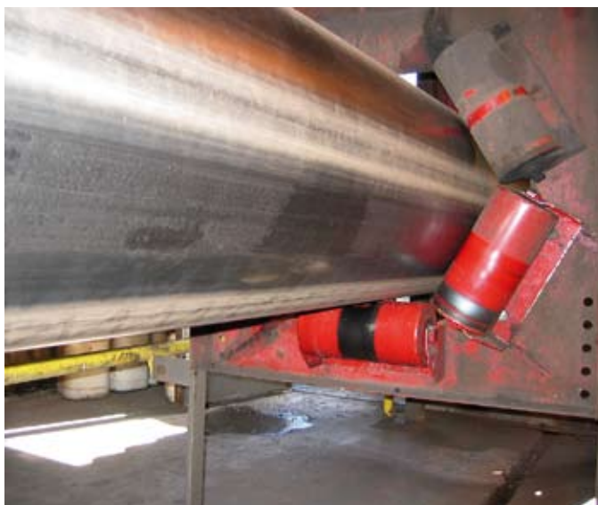
Рис. 10. Новая трубчатая лента контактирует со всеми роликами как в рабочей ветви (слева), так и в холостой ветви (справа)
