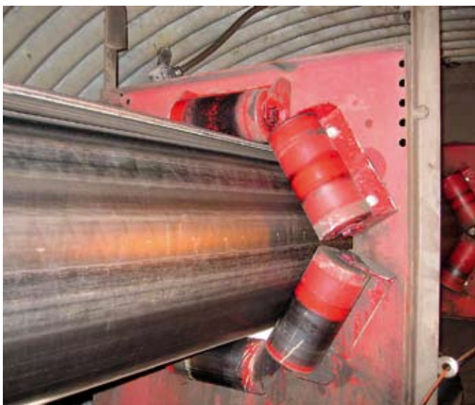
Рис. 10. Новая трубчатая лента контактирует со всеми роликами как в рабочей ветви (слева), так и в холостой ветви (справа)
