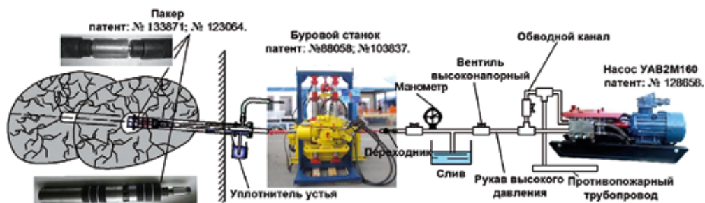
Рис. 3. Технологическая схема выполнения ориентированного поинтервального гидроразрыва пласта через дегазационную скважину
