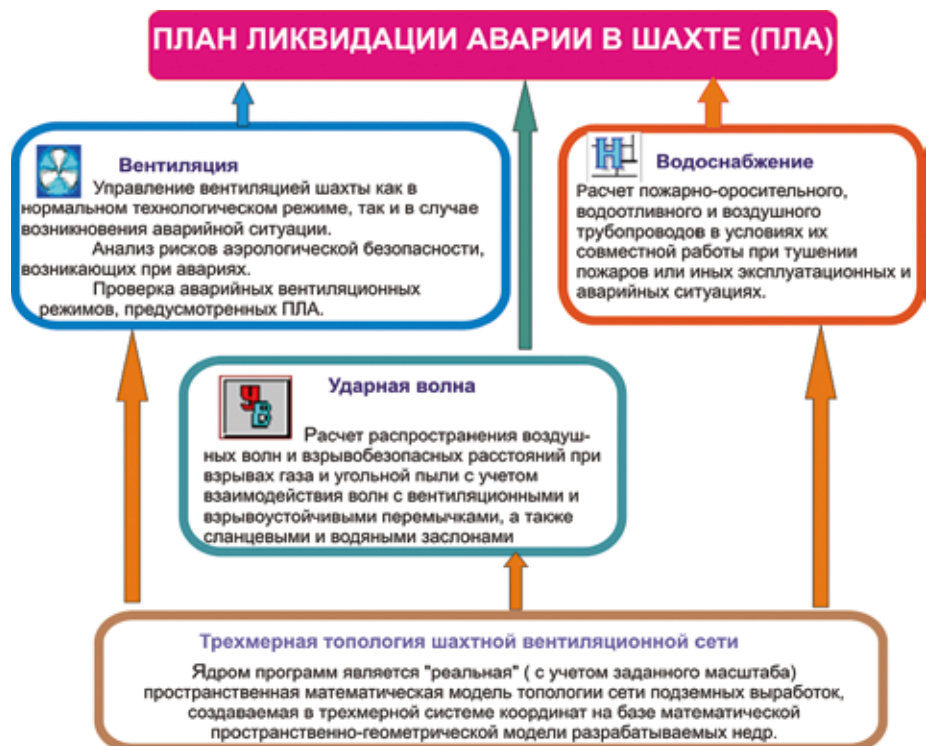
Рис. 2. Структурная схема программных (противоаварийных) комплексов [8, 9]
