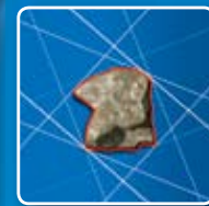
Каждая частица сканируется в 64 направлениях
