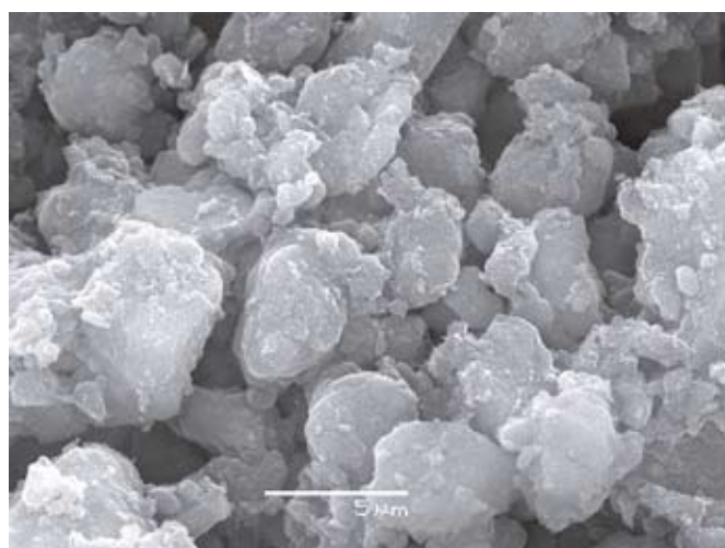
Рис. 2. Пористая структура блоков (снимок получен с помощью сканирующего электронного микроскопа) Fig. 2. Porous block structure (the picture is taken using the scanning electronic microscope)
