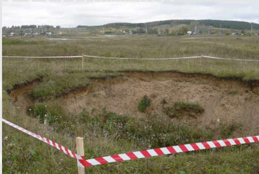
Рис. 3. Провал на горном отводе ликвидируемой шахты «Ягуновская» от очистных работ по пласту «Волковский»
