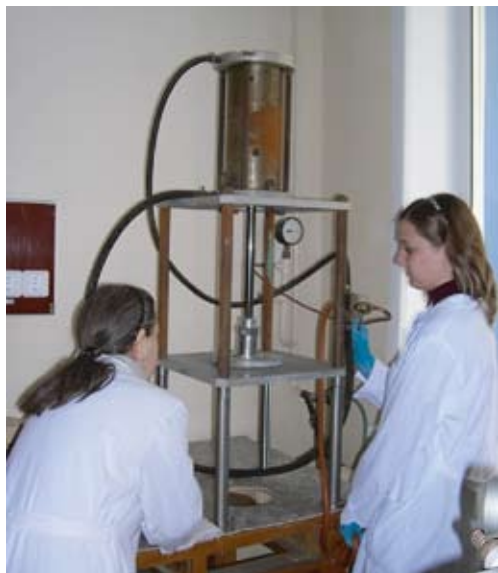
Рис. 3. Изготовление блочных носителей: а — формование блоков на пневмопрессе; б — носители различной химической природы Fig. 3. Manufacturing of block carriers: а — block formation using the pneumatic press; б — carriers of the different chemical nature
