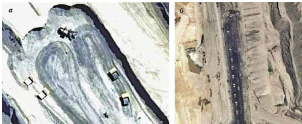
Рис. 3. Фрагменты космоснимков с изображением организационных схем отработки экскаваторных забоев: а – забой верхнего вскрышного уступа с карьерным гусеничным экскаватором типа прямая лопата; б – отработка угольного пласта карьерным гусеничным экскаватором типа прямая лопата в тупиковом забое
