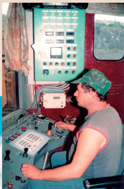
В кабине бурового станка СБШ-160/200-40
