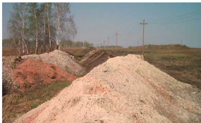
Рис. 3. Фрагмент поверхности бурта ПСП, покрытого подстилающими карбонатными породами (угольный разрез «Бородинский», слева — май 2005 г., справа — май 2007 г.)
