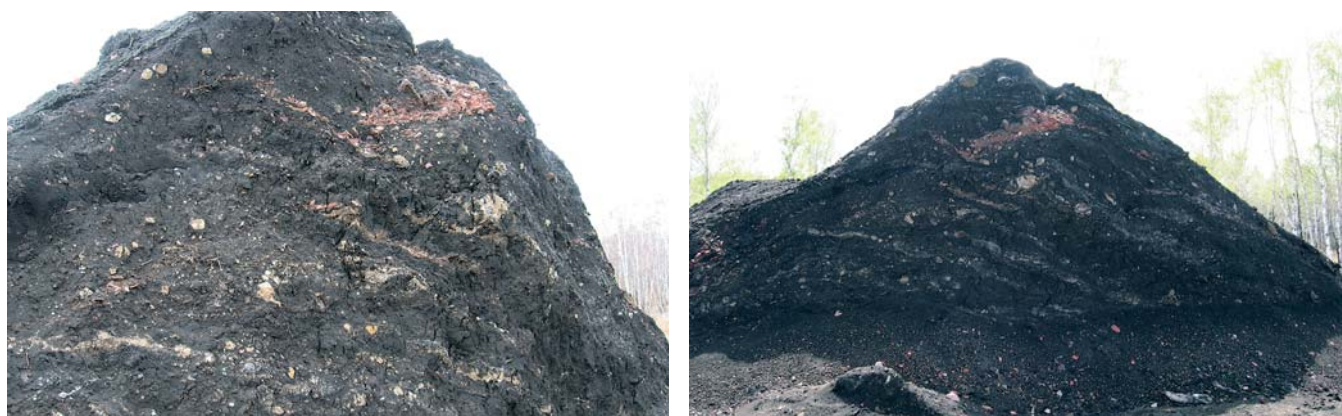
Рис. 5. Поперечное сечение бурта ПСП, засоренного подстилающими вскрышными породами (восточный фланг угольного разреза «Бородинский», май 2007 г.)
