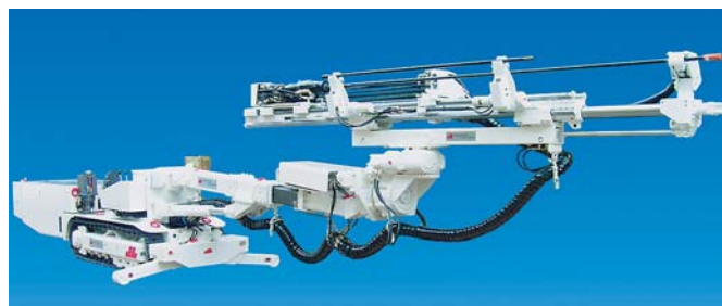
Рис. 3. Бурильная установка типа BTRL1
