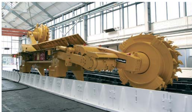
Рис. 1. Комбайн Айкхофф SL500: диапазон резания 2,7 — 6 м Двигатель резания, кВт 2 x 825 Двигатель подачи (АС), кВт 2 x 90 Двигатель гидравлики, кВт 35 Масса, т 110
