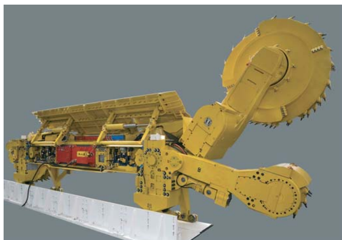
Рис. 4. Поворотная рукоять комбайна SL1000 на испытательном стенде
