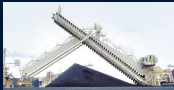
Портальный скребковый реклаймер типа SCHADE с двойной стрелой
