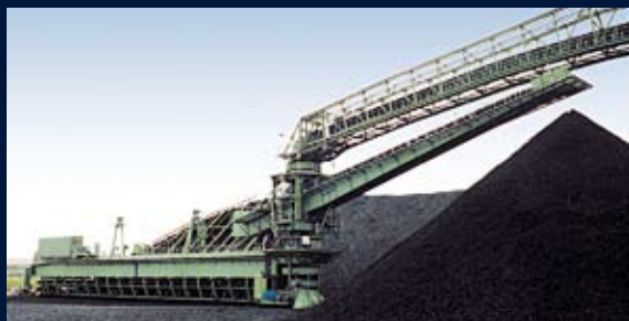
Круглый склад с мостовым скребковым реклаймером типа SCHADE
