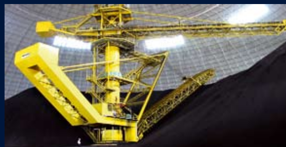
Круглый склад с боковым скребковым реклаймером типа SCHADE
