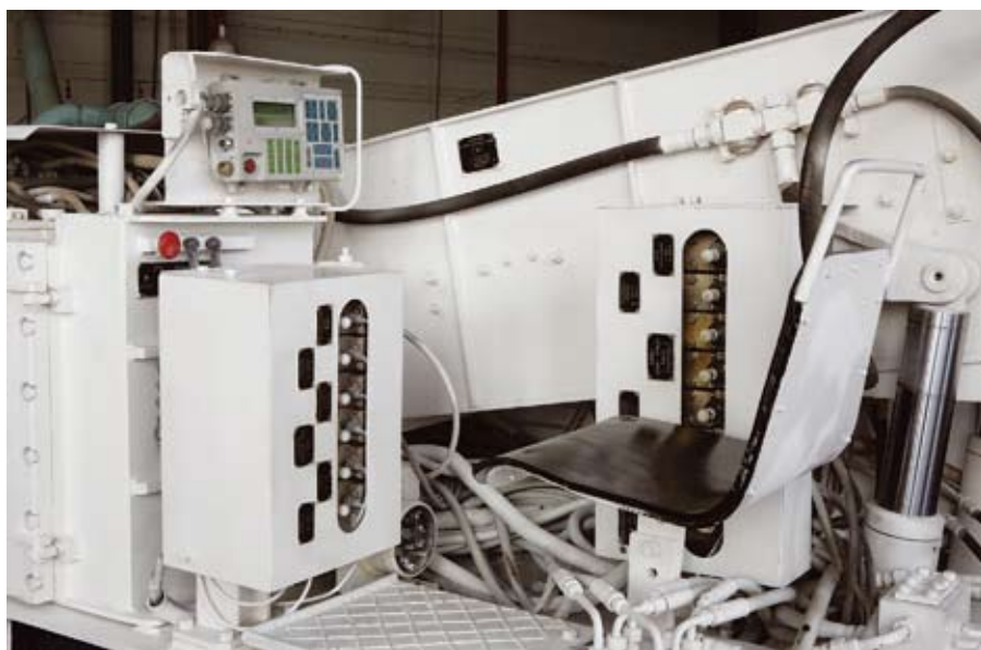
Проходческий комбайн КП21-02 с дистанционным управлением
