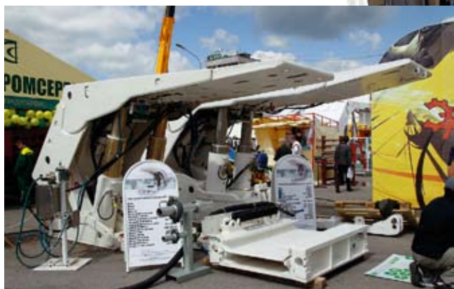
Секции щитовой механизированной крепи ДБТ, группы 2 и 3 после ремонта
