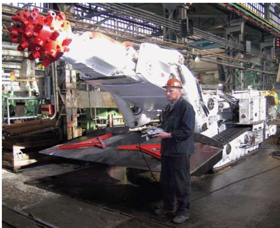
Проходческий комбайн КП21-02 с дистанционным управлением
