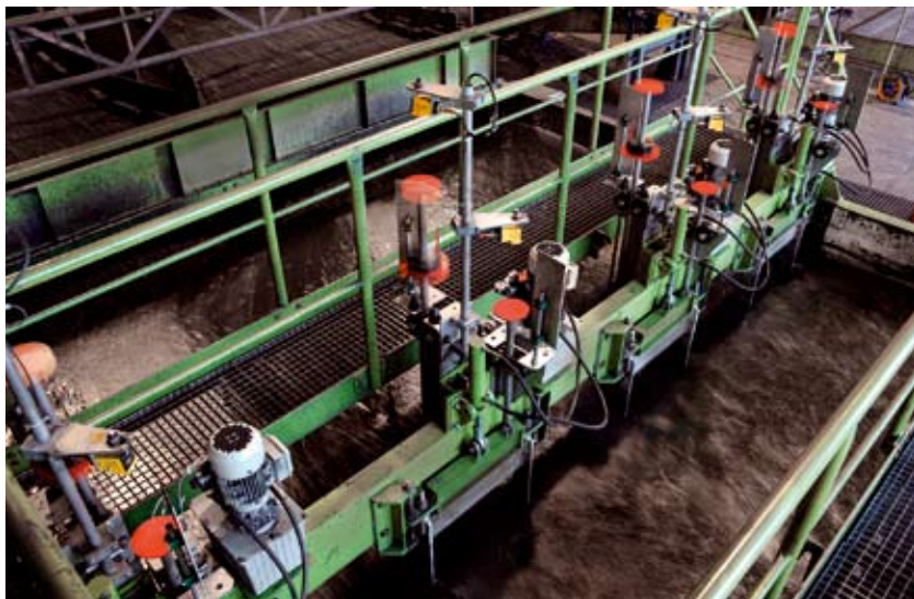
Экономичное обогащение угля с помощью отсадочной машины БАТАК.
