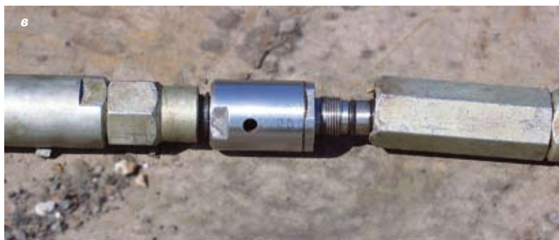
Рис. 6. Уравновешенный пакер: внешний вид пакера (а); клапан (б) и его внешний вид (в): 1 — золотник; 2 — рабочая пружина; 3 — втулка; 4 — уплотнение; 5 — отверстие для прохода рабочей жидкости; 6 — стакан; 7 — уплотнение
