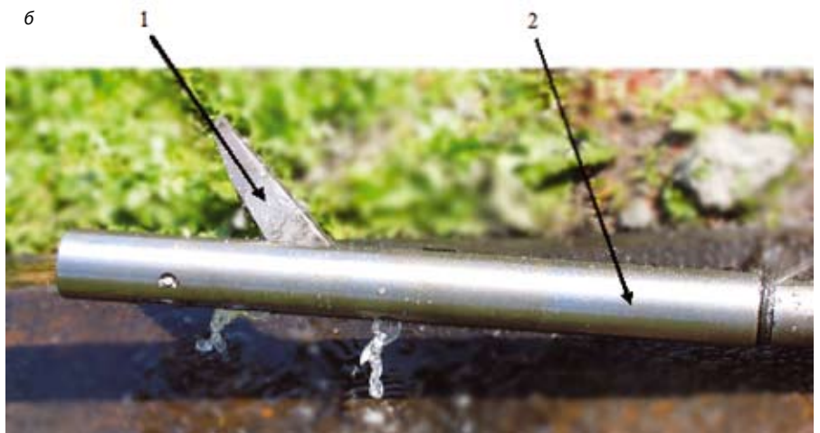
Рис. 3. Общий вид щелеобразователей: а — двусторонний, б — односторонний; 1 — резец, 2 — корпус
