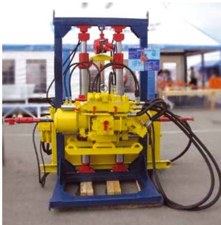
Рис. 1. Внешний вид и кинематическая схема бурового станка СБР—400
