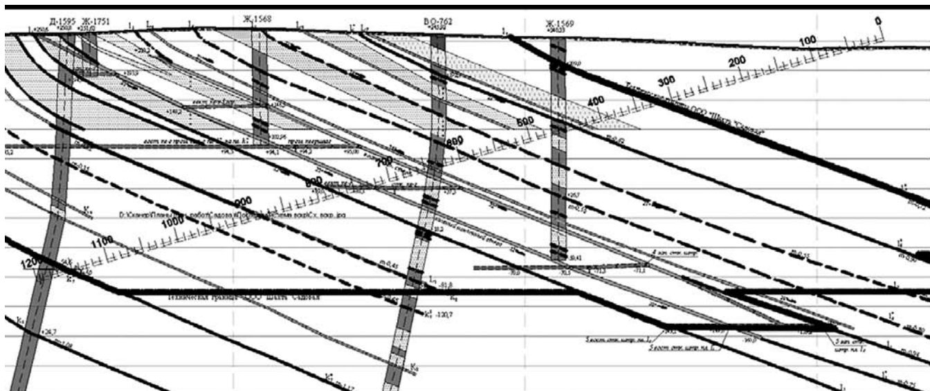
Рис. 1. Разрез горной породы по пластам наклонного шахтного ствола
