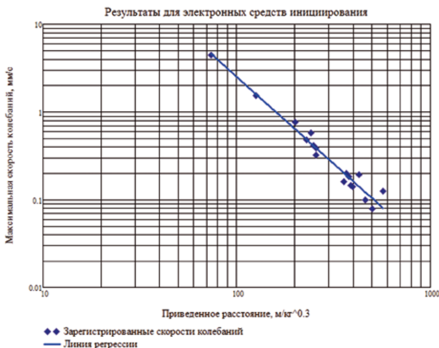
Рис. 2. Прогнозируемая скорость колебаний в зависимости от приведенного расстояния для взрывов с использованием систем электронного взрыва
