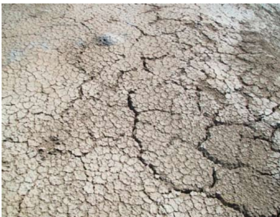
Рис. 2. Потрескавшееся покрытие отвала
