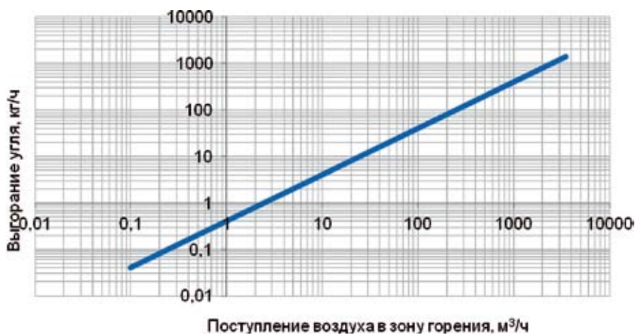
Рис. 3. Скорость выгорания угля в зависимости от интенсивности подачи воздуха к очагу горения при содержании углерода в массиве 23 %
