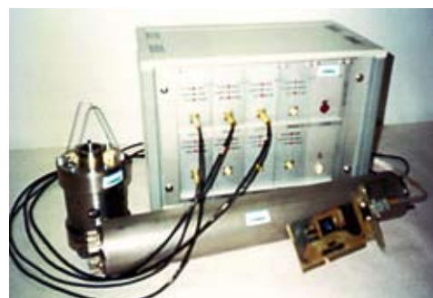
Основные элементы системы сейсмического мониторинга GITS: базовый модуль системы GITS, плата сопряжения, выносной модуль
