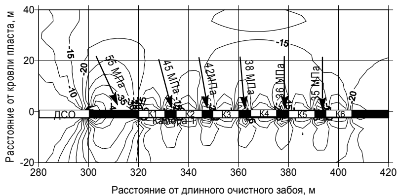
Рис. 3. Распределения вертикальных напряжений в междукамерных целиках: величины и направления максимальных нормальных напряжений в угольных целиках указаны векторами; К1, К2...К6 — номера камер
