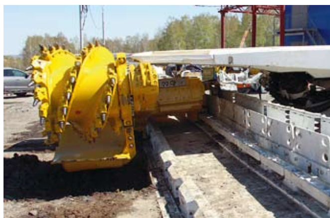
Рис. 1. Контрольная сборка очистного комбайна EICKHOFF SL-300 с лавным оборудованием на поверхности шахты «Польсаевская»
