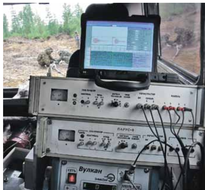
Рис. 2. Аппаратура волнового акустического каротажа «ПАРУС-8» в комплексе с цифровым каротажным регистратором «Вулкан»
