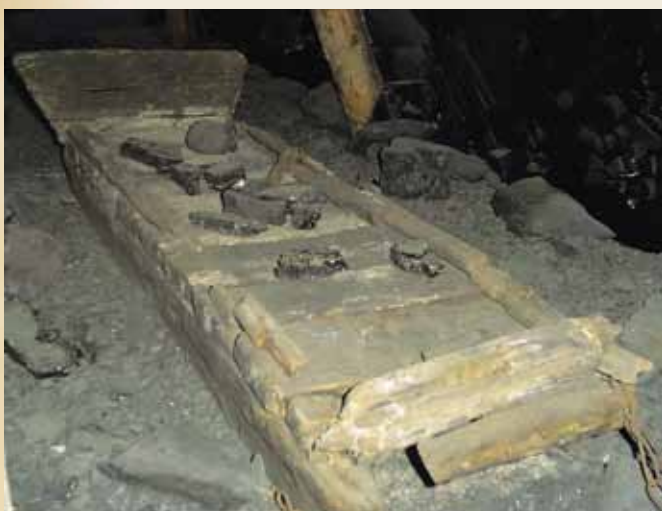
Санки для доставки угля в дореволюционной шахте. Подлинный экспонат. В таких санках тягальщик мог везти до 150 кг угля
