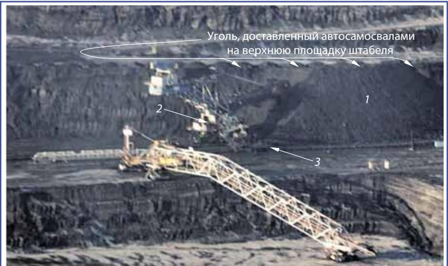
Рис. 12. Технологическая схема ЦПТ на разрезе «Богатырь» (Экибастузский угольный бассейн, Казахстан), предполагающая выемку угля одноковшовыми экскаваторами, доставку его в усреднительно-аккумулирующий штабель (1) автотранспортом с последующим дроблением угля роторным колесом и встроенной дробилкой роторного экскаватора (2) и погрузкой дробленого угля (фракции 0–350 мм) на забойный конвейер (3)
