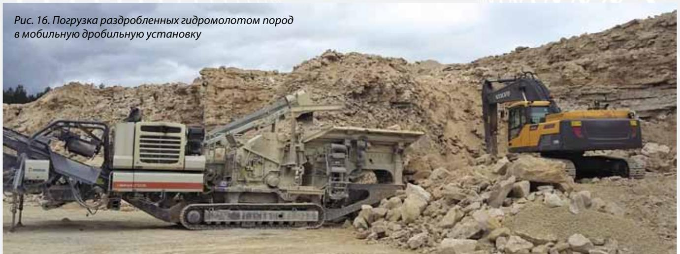
Рис. 16. Погрузка раздробленных гидромолотом пород в мобильную дробильную установку
