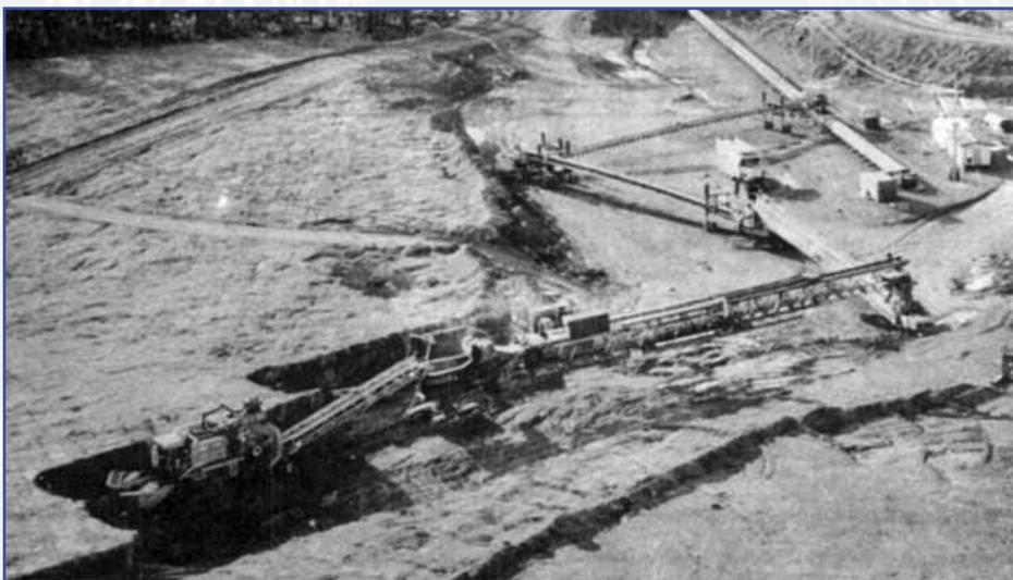
Рис. 3. Работа комбайна Dosco TB-300 в комплексе с мобильными конвейерными перегружателями [2]
