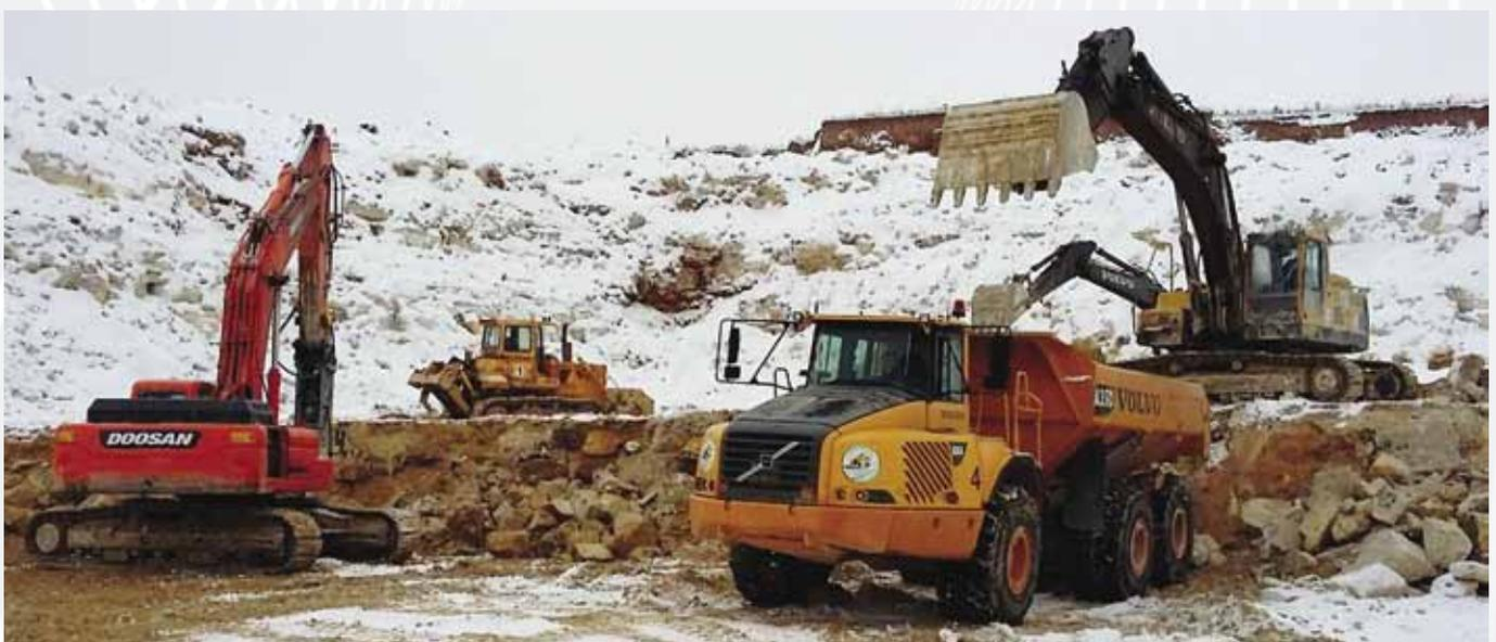
Рис. 14. Работа комплекса выемочно-погрузочного оборудования (гидравлический экскаватор «обратная лопата» – гидравлический экскаватор с гидромолотом) при разборке слоистого карбонатного массива с мощностью разностных слоев от 0,3 до 0,8 м в пределах одного технологического уступа (Акатьевский карьер)
