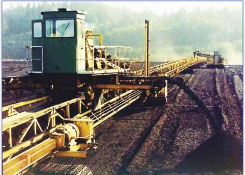
Рис. 5. Конвейерная установка фирмы Rahco (FLSmidth's) для работы в комплексе с комбайном непрерывного действия
