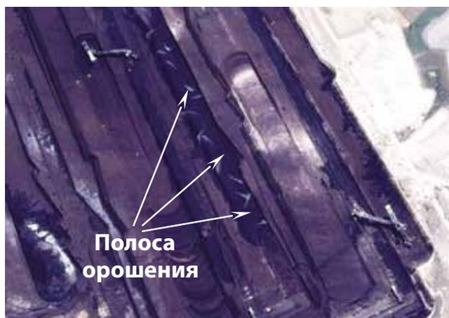
Рис. 1. Орошение поверхности угольного пласта на разрезе «Тралалгон Восток»
