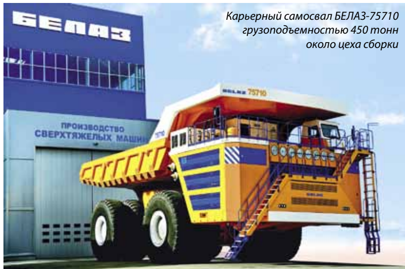
Карьерный самосвал БЕЛАЗ-75710 на испытательном полигоне ОАО «БЕЛАЗ»
