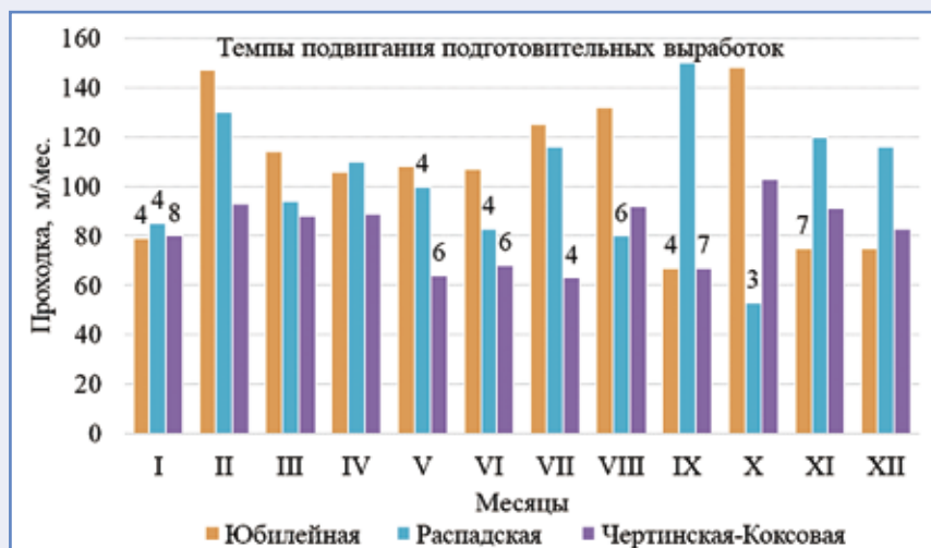
Рис. 2. Гистограмма темпов подвигания подготовительных забоев, причины отклонения: 3 – зона повышенной трещиноватости; 4 – геологическое нарушение; 6 – переезд сопряжения со сбойкой; 7 – зона куполения пород кровли; 8 – зона повышенного газовыделения Fig. 2. A histogram of the rates of advancement of the preparatory faces, the reasons for the deviation: 3 – zone of hanging fracture; 4 – geological disturbance; 6 – moving pairing with a failure; 7 – zone domed roof rocks; 8 – zone of increased gas evolution
