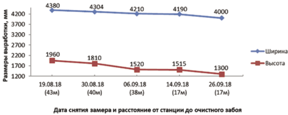
Рис. 5. Размеры конвейерного штрека № 555 на замерной станции № 1 (вне зоны НГР) Fig. 5. Dimensions of conveyor drift No. 555 at metering station No. 1 (outside the oil and gas region)
