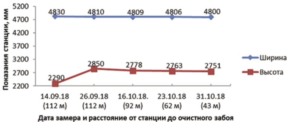
Рис. 8. Размеры конвейерного штрека № 555 на замерной станции № 3 (в зоне НГР) Fig. 8. Dimensions of conveyor drift No. 555 at metering station No. 3 (in the oil and gas region)
