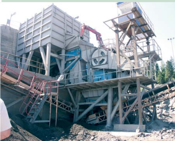
Мобильный комплекс первой стадии дробления СМ-1208 фирмы «Sandvik Rock Processing»
