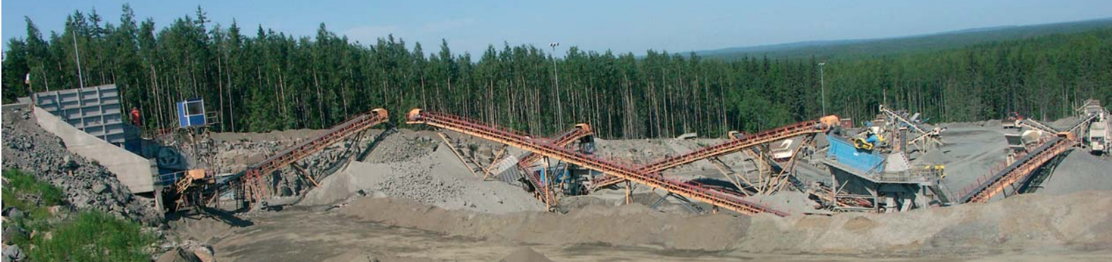
Мобильный комплекс первой стадии дробления СМ-1208 фирмы «Sandvik Rock Processing»
