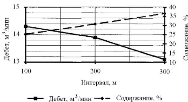
Рис. 4. Зависимость дебита и содержания метана от интервала между скважинами
