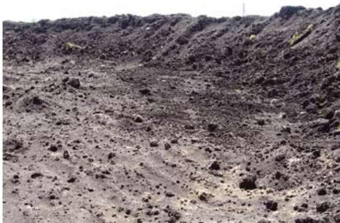
Рис. 6. Фрагмент основания экскаваторного забоя после отгрузки ПСП (угольный разрез «Бородинский»)
