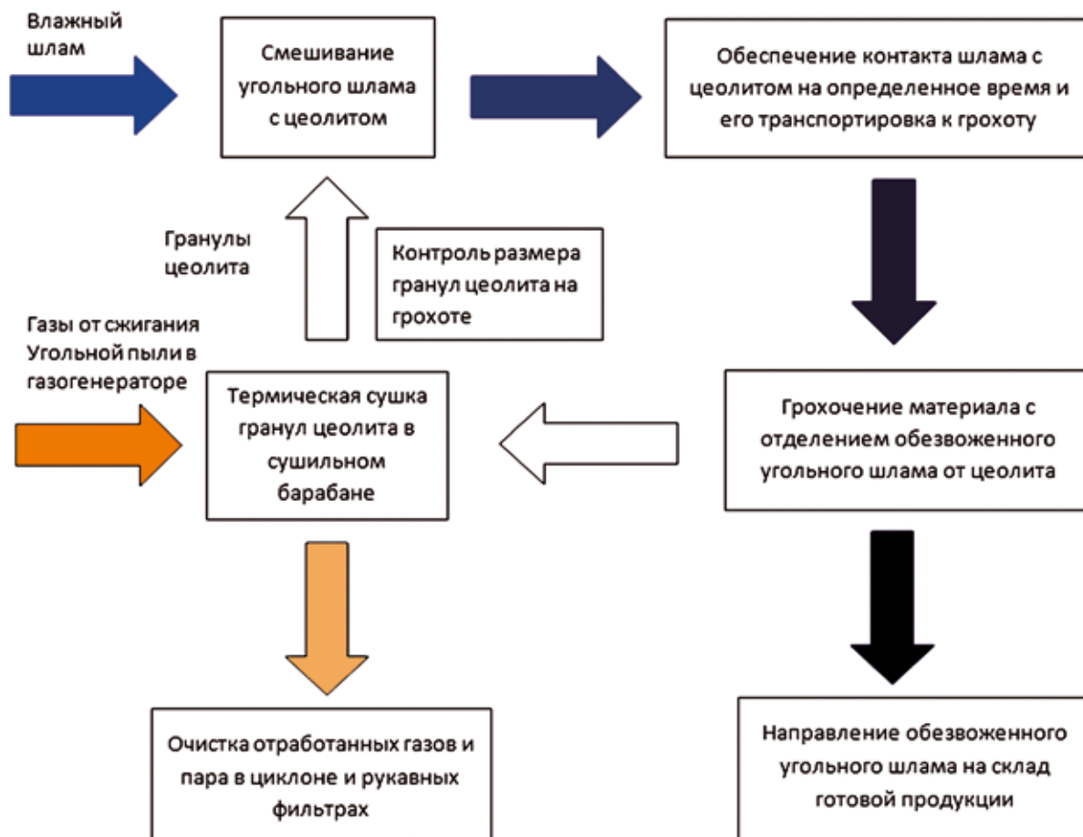
Рис. 3. Блок-схема установки глубокого обезвоживания угольного шлама с использованием гранул цеолитов
