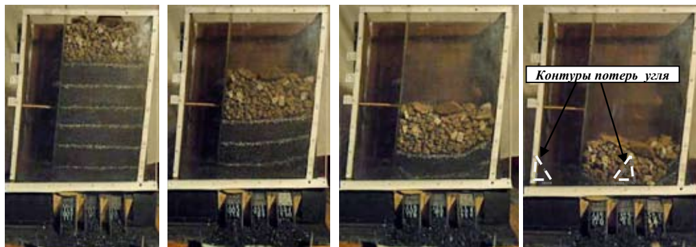
Рис. 4. Моделирование управляемого площадного выпуска (механизированный комплекс КПВ1)
