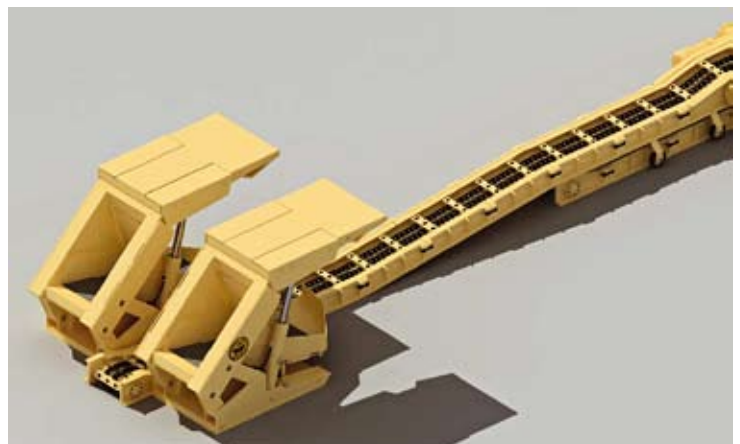
Рис. 2. Механизированные комплексы для отработки мощного крутого пласта подэтажами с выпуском: а — механизированный комплекс КПВ-1 (Институт угля СО РАН); б — механизированный комплекс ВМВ-10 (Словения).
