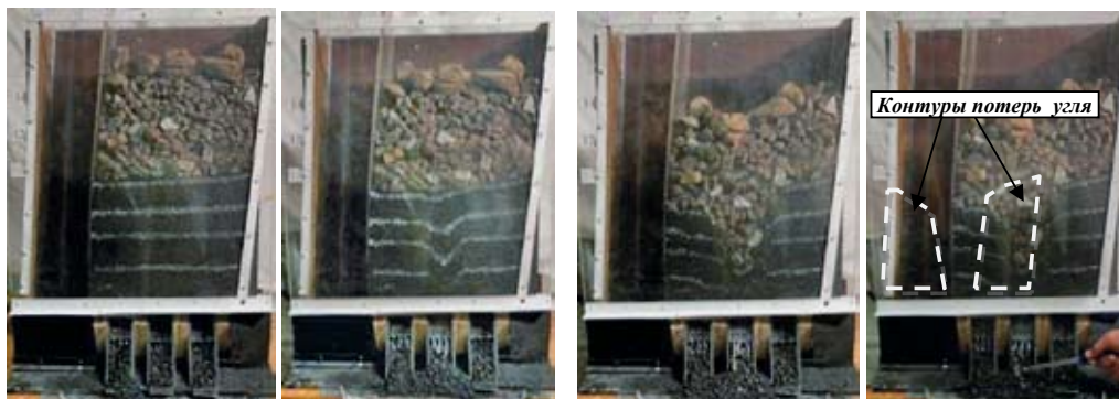
Рис. 3. Моделирование выпуска угля на конвейер через центральное окно между секциями крепи (механизированный комплекс ВМВ-10)
