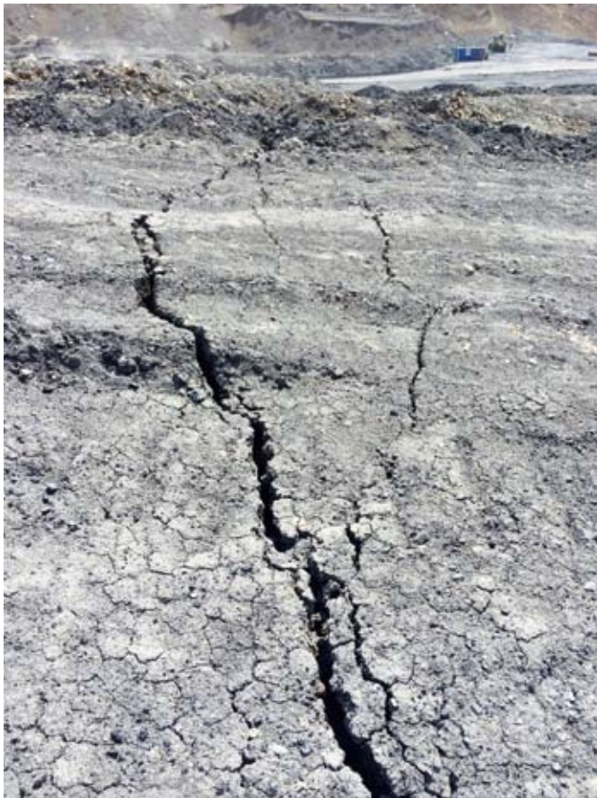
Рис. 3. Образование трещин, выходящих на вышележащий горизонт
